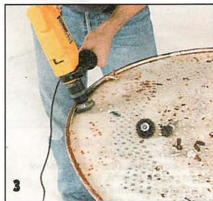
Из швов лак удаляют дисковой проволочной щёткой, одновременно очищая их и от ржавчины.
