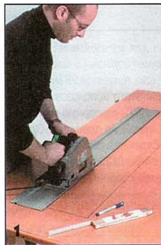
Ручной дисковой пилой в дверном полотне выпиливают вырез.
