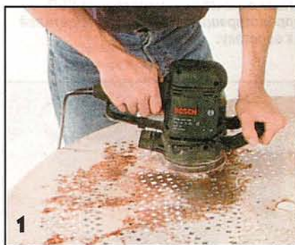
Удалить старое покрытие со слегка выпуклых поверхностей лучше всего эксцентриковой шлифовальной машинкой.
