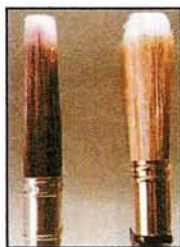
У высококачественной кисти (слева) щетина тоньше и сужается она плавнее, чем у кисти более низкого качества (справа).
